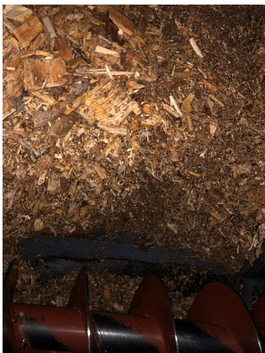
Holzschnitzelförderung aus den Holzsilos
